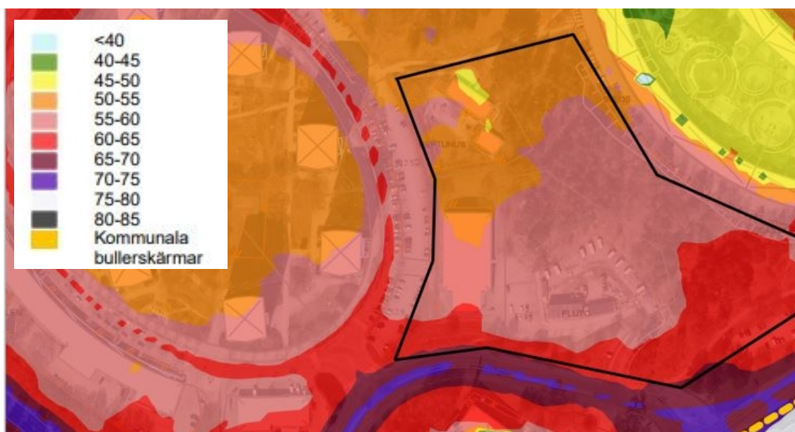
Figur 19 Befintliga bullernivåer inom fastigheterna Neptuneus 1 och Pluto 1. Del av bullerskärm längs E18 visas med gult, till höger i bild (Norconsult, 2022). Byggnaderna (förskolan) i norra delen av planområdet är numera rivna.
